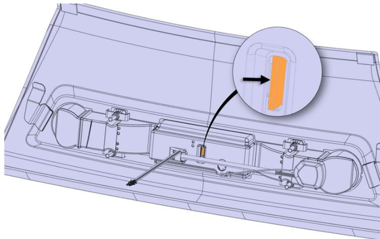
13. Rebrancher le connecteur de l'horloge et rattacher le panneau du plafond avec le Velcro en haut.
