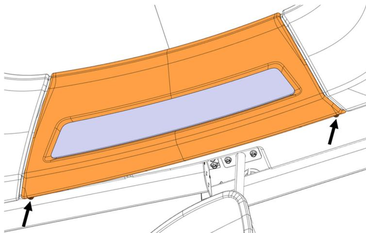
2. Détacher le velcro et retirer le panneau central du plafond. Débrancher le connecteur de l'horloge.
