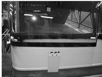
8. Soulever puis incliner la section de pare-brise. Insérer le premier coin. Pousser sur le pare-brise vers la gauche, il doit être bien appuyé dans le fond du joint de caoutchouc.
