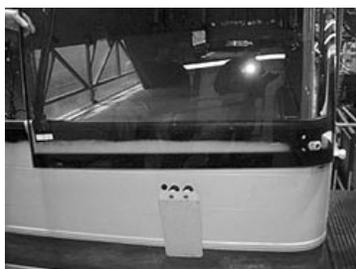
20. Soulever puis incliner la section de pare-brise. Insérer le premier coin puis le centre du pare-brise.
