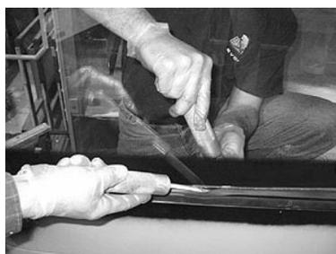
22. S'assurer que le bas du pare-brise est bien appuyé dans le fond de la rainure du joint de caoutchouc.
