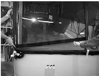
9. Insérer le bas du pare-brise avec la lame de plastique.
