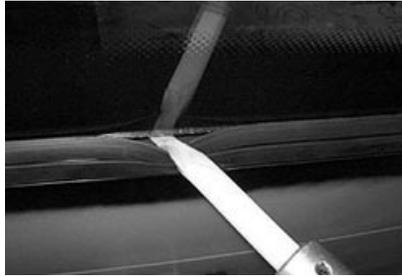
11. Tout en maintenant une pression sur la section de pare-brise, insérer chaque côté dans le joint de caoutchouc.
