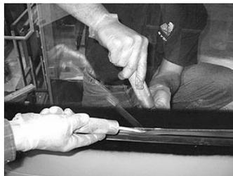
10. S'assurer que le bas du pare-brise est bien appuyé dans le fond de la rainure du joint de caoutchouc.
