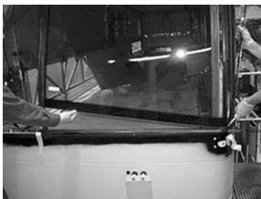
21. Insérer le bas du pare-brise avec la lame de plastique. Pousser sur la section de pare-brise à partir de l'extérieur.
