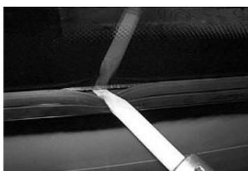
23. Maintenir une pression sur la section de pare-brise. Insérer chaque côté de la section dans le joint de caoutchouc tout en tirant sur la corde.
