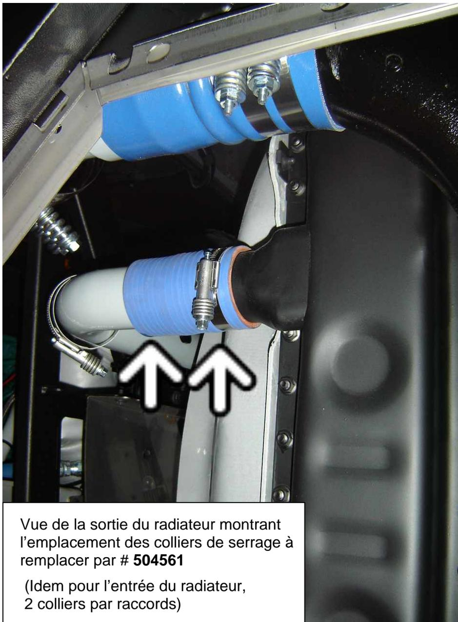
8. Sur le boyau de raccordement du radiateur, situé à proximité du turbocompresseur, remplacer le collier de serrage (pièce 2 figure 1) par un collier de serrage # **504561**.
