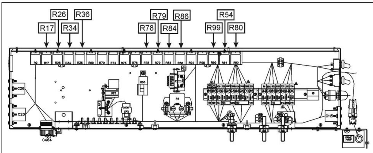
FIGURE 2 : BOITE DE JONCTION ARRIÈRE SUR VÉHICULE DE TYPE ENTERTAINER
