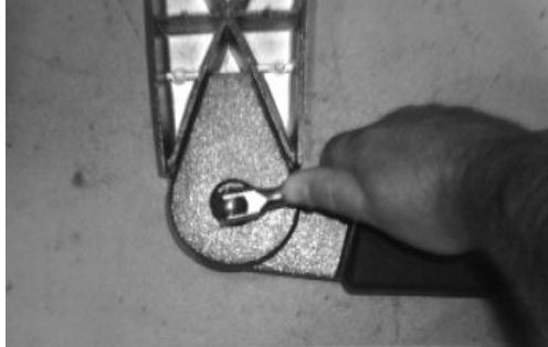
FIGURE 9: INSTALLATION DE L'ÉCROU 18223
