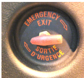
FIGURE 4: SOUPE INTÉRIEURE D'OUVERTURE D'URGENCE
