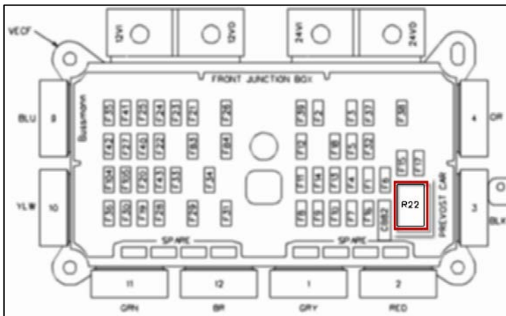
Figure 2 Emplacement habituel de R22 dans le VECF.
