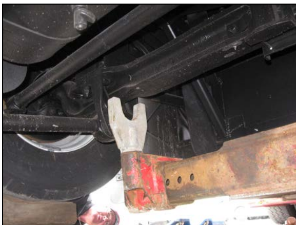
LEVAGE PAR L'ESSIEU AVANT
