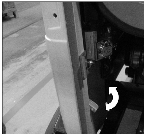
OUVERTURE DE LA PORTE MOTEUR ARRIÈRE
