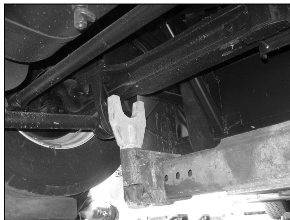
LEVAGE PAR L'ESSIEU AVANT
