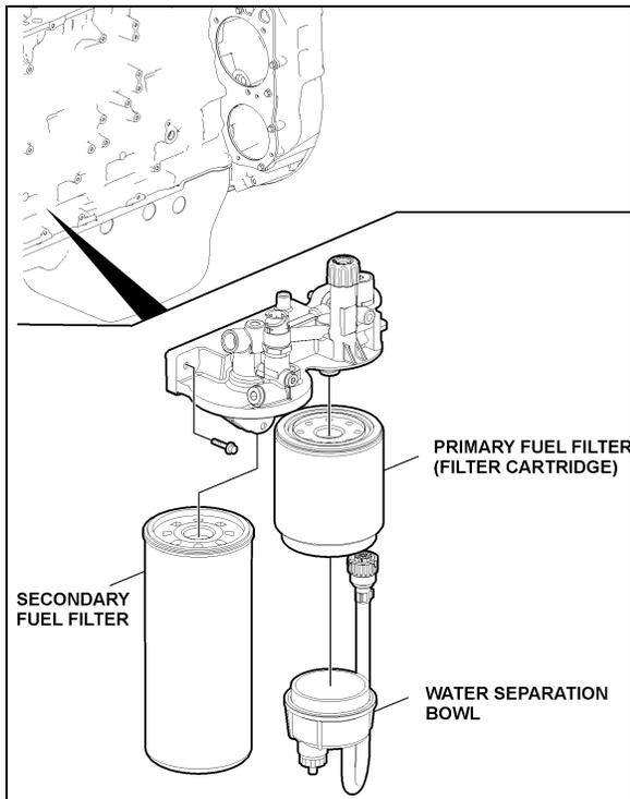
FUEL FILTERS WITH VOLVO D13 ENGINE 03085
