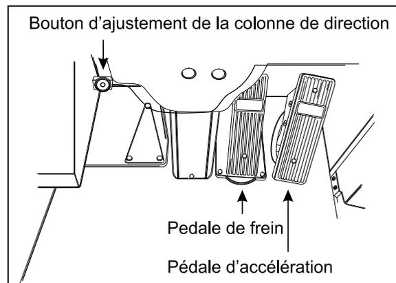
INCLINAISON ET RÉGLAGE TÉLESCOPIQUE
