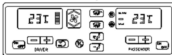
L'intérieur de l'autocar est pressurisé par le système de chauffage et de climatisation afin de prévenir l'introduction de la poussière et de l'humidité. Le débit d'air et les commandes divisent l'intérieur de l'autocar en deux zones, soit :
