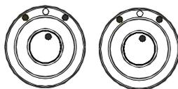
Tourner le bouton vers la gauche pour l'ajustement du miroir plat du rétroviseur et vers la droite pour l'ajustement du miroir
