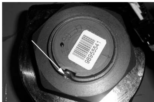
FIGURE 13 : MARQUE DE POINÇON D'ÉCROU DE FIXATION
