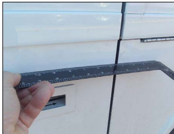
FIGURE 57: UTILISER UNE RÈGLE POUR VÉRIFIER SI LES SURFACES SONT AU MÊME NIVEAU
