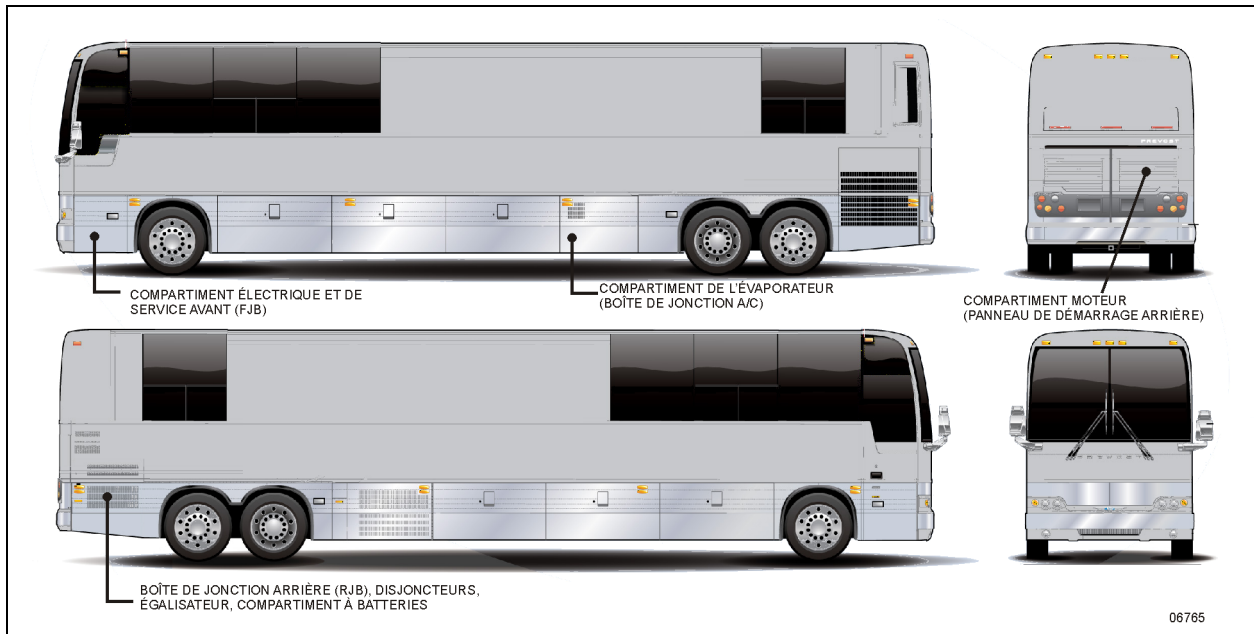
FIGURE 14 : COMPARTIMENTS ÉLECTRIQUES (X3-45 VIP)
