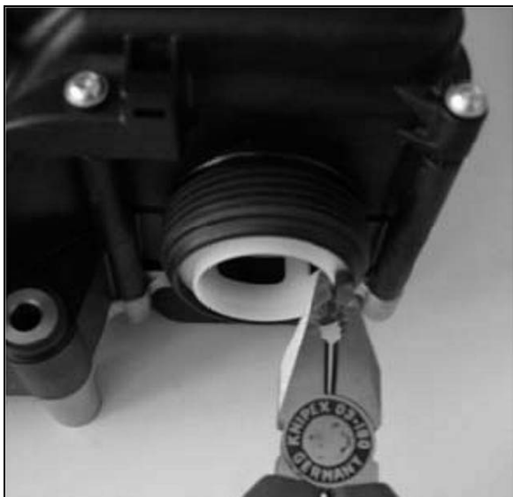
FIGURE 12 : REMPLACEMENT DE L'ÉLÉMENT FILTRE DU MODULE DE POMPE
