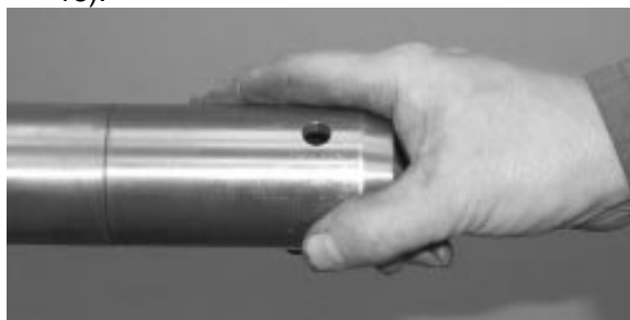
FIGURE 18 : OUTIL D'INSERTION N/P PREVOST 491115
