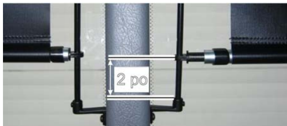
FIGURE 21: AJUSTEMENT D'USINE DES POSITIONS DE FIN DE COURSE SUPÉRIEURE ET INFÉRIEURE
