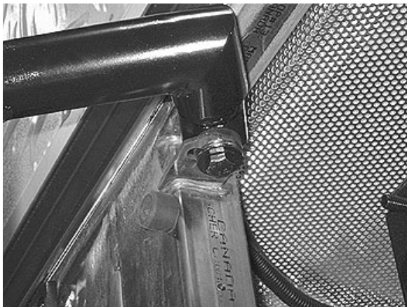
FIGURE 76: AJUSTEMENT DE LA PROFONDEUR DE LA PORTE
