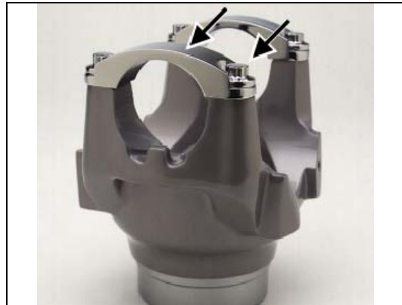
FIGURE 3 : RETENUE DE PALIER FORMÉE À FROID ET BOULONS TEL QU'UTILISÉ SUR LES VÉHICULES PREVOST
