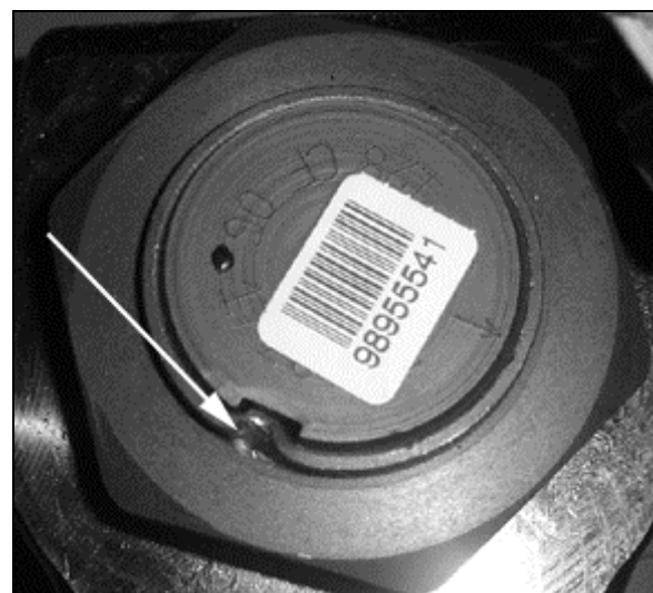
FIGURE 20 : MARQUE DE POINÇON D'ÉCROU DE FIXATION
