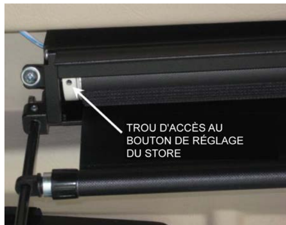
FIGURE 20 : PARE-SOLEIL DU CONDUCTEUR
