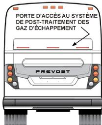
La porte d'accès au moteur doit être ouverte avant d'ouvrir la porte d'accès au système de post-traitement des gaz d'échappement. Pour ouvrir la porte, abaisser le bouton du loquet.
