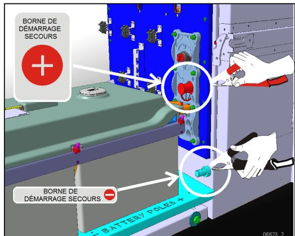
POSITION DES BORNES POUR DÉMARRAGE-SECOURS
