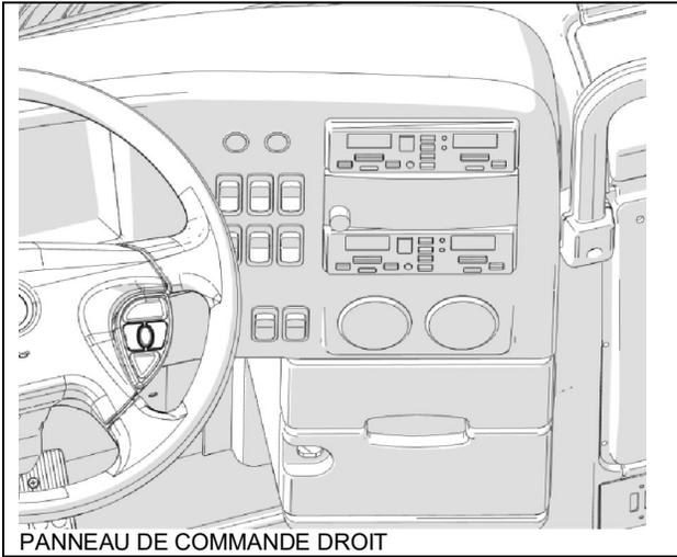
Le panneau de commande droit du tableau de bord comprend les interrupteurs de commande pour l'éclairage intérieur de l'autocar. Il comprend également les interrupteurs de la porte d'entrée, l'interrupteur de la caméra du système de visionnement des scènes panoramiques, le bouton de réglage de l'intensité lumineuse, le système de divertissement, l'unité de commande de CVC ainsi que des bouches d'air réglables pour le conducteur.
