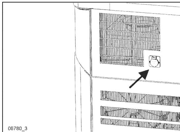
PRISE DU CHARGEUR À BATTERIES 120 VOLTS
