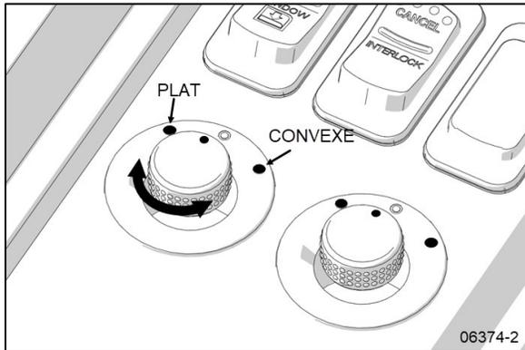
**COMMANDES DE RÉGLAGE DES RÉTROVISEURS 06374**
