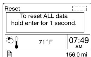
Lorsque ce menu est sélectionné, appuyer et maintenir la touche **ENTRÉE** ← pendant 1 seconde pour remettre à zéro les fonctions listées plus bas. Cette fonction permet au système de remettre à zéro les résultats des calculs.
