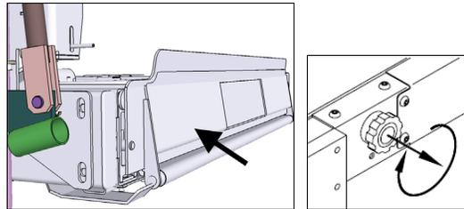
2. Lever la tige du détendeur de pression jusqu'à ce que la plateforme commence à s'abaisser (l'ouverture de la valve fait descendre la plateforme).
