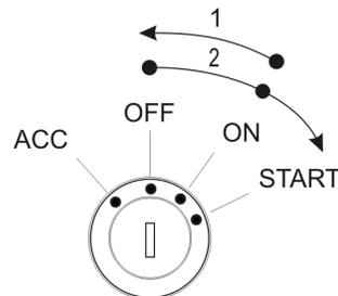
1. À partir de la position ON, placer le commutateur à la position OFF
