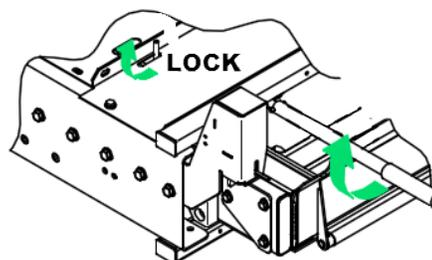
6. Soulever la main courante de droite à la verticale et pousser fermement vers le bas pour l'enclencher dans son réceptacle. Répéter pour la main courante de gauche.
