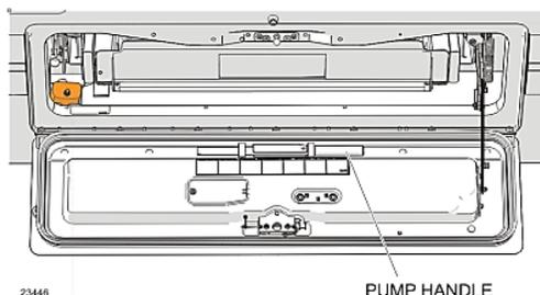
3. Engager l'arbre de déverrouillage de la plateforme dans l'extrémité du levier de la pompe.
