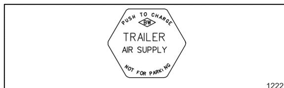
Le système de freinage de la remorque est alimenté lorsqu'on enfonce le bouton de cette valve de commande.
