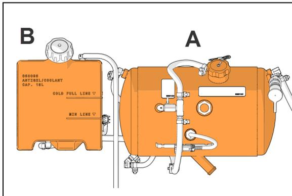
Vérifier le niveau de liquide de refroidissement dans le réservoir de récupération lorsque le moteur est froid (température ambiante).
