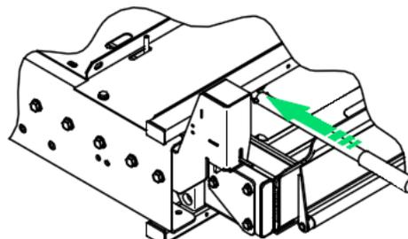
4. Tourner l'extrémité de l'arbre de déverrouillage de la plateforme de 1/4 de tour à l'aide du levier de la pompe de secours puis soulever le verrou illustré à droite.
