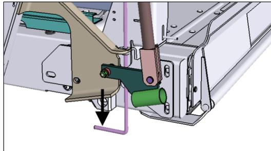
2. Élever la plateforme jusqu'à la hauteur de rétraction; positionner la surface supérieure du cadre de levage à la même hauteur que la surface supérieure du charriot. Si la position exacte ne peut être atteinte, il est préférable que ce soit légèrement plus bas plutôt que légèrement plus haut. Cet alignement élimine les interférences entre la plateforme et le boîtier lorsque vous poussez la plateforme à l'intérieur du boîtier.
