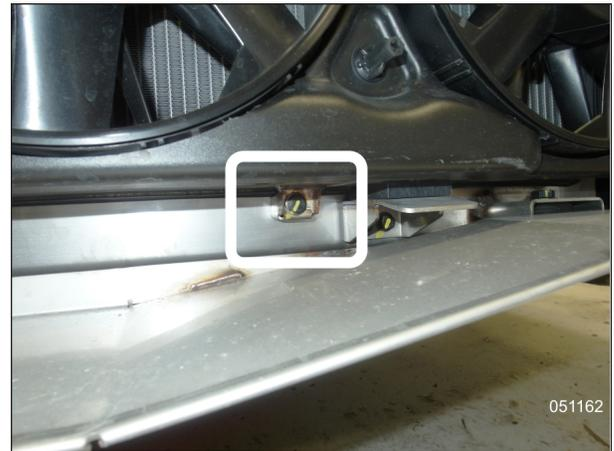
FIGURE 14: FAN SHROUD TOP & BOTTOM HOLD-DOWN SCREWS
