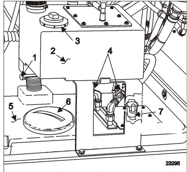
FIGURE 2: DUAL LAVATORY WASTE WATER TANK OPTION
