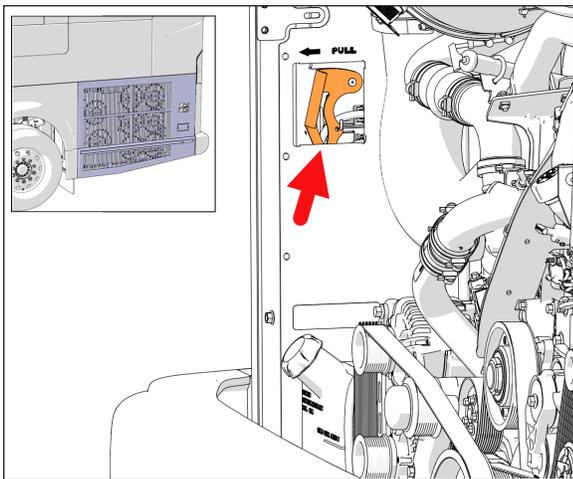
FIGURE 31: RADIATOR DOOR LATCH RELEASE LEVER LOCATION
