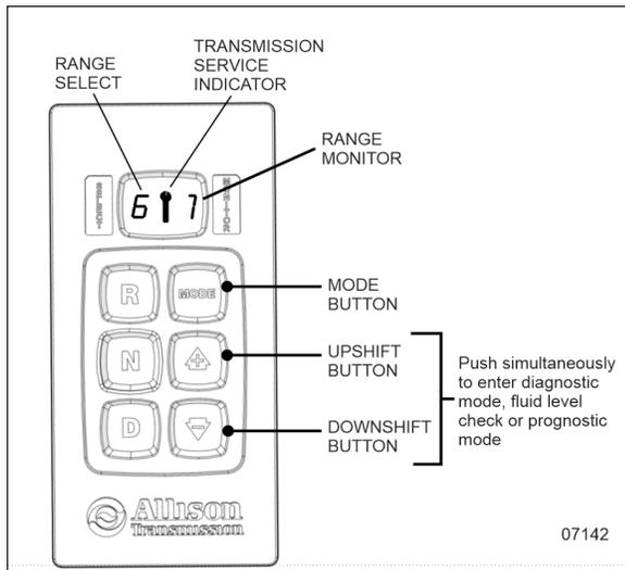
FIGURE 55: ALLISON PUSHBUTTON SHIFT SELECTOR
