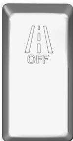
Pour éviter les alertes erronées dans certaines zones telles que les zones de travail où les marquages routiers présents peuvent causer de fausses alertes, la fonction d'avertissement de sortie de voie LDW peut être désactivée par le conducteur à l'aide de cet interrupteur. La fonction d'avertissement de sortie de voie LDW se réactive automatiquement après un délai de 15 minutes ou en appuyant sur cet interrupteur une deuxième fois pour réactiver la fonction.
