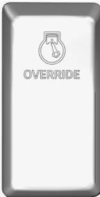
Basculer cet interrupteur sur le tableau de bord ou le bouton Delay Engine Stop du panneau de commande AFSS pour retarder de 15 secondes additionnelles l'arrêt automatique du moteur ainsi que la libération de l'agent d'extincteur chimique.
