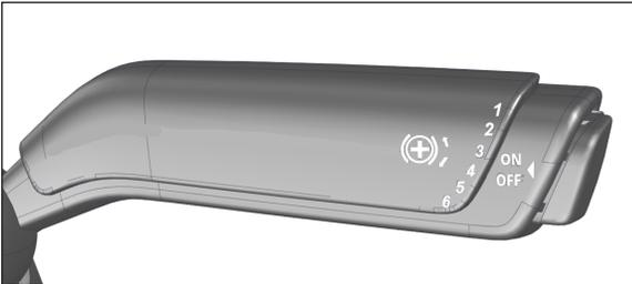
FIGURE 30: BRAS DE COMMANDE DU RALENTISSEUR DE TRANSMISSION
