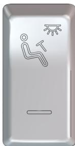
Basculer cet interrupteur pour allumer les plafonniers situés au-dessus du conducteur.
