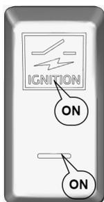
L'interrupteur principal d'alimentation est en position ON et l'interrupteur d'allumage est basculé en position ON.
