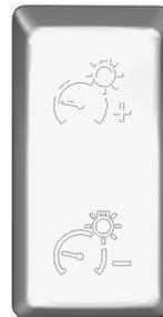
Ajuste l'intensité lumineuse des instruments et des interrupteurs.
