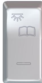
Cet interrupteur assure l'alimentation électrique des lampes de lecture permettant aux passagers de commander l'éclairage de leur lampe personnelle.
