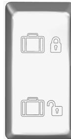
Permet de verrouiller et déverrouiller l'ensemble des compartiments à bagages.
