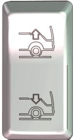
Basculer momentanément l'interrupteur vers le bas pour abaisser l'avant de l'autocar de 100 mm (4 pouces).
