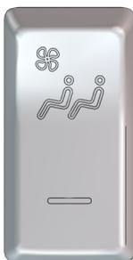
Basculer cet interrupteur afin de mettre en marche les ventilateurs de la console des passagers.
