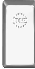
Dans certaines situations, il peut être utile de retarder l'intervention du dispositif antipatinage à l'accélération. Le mode Neige/Boue permet une puissance de moteur accrue et permet une rotation (patinage) des roues plus importantes durant le fonctionnement du dispositif TCS. Cette fonction est utile lorsqu'il est difficile de mettre le véhicule en mouvement comme sur une chaussée glacée par exemple.
