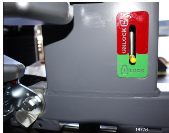
FIGURE 17: VERROUILLAGE SECONDAIRE
