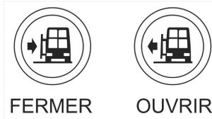
Appuyer sur ces boutons pour ouvrir et fermer la porte avant du véhicule.
