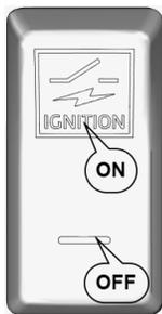
Véhicule en mode réveil : pictogramme allumé (ON) et DEL allumée (ON).
