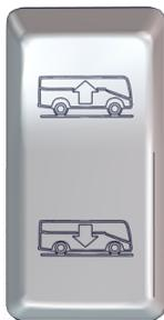
Basculer et maintenir l'interrupteur pour élever ou abaisser l'autocar de 100 mm (4 pouces). Relâcher l'interrupteur et le véhicule reprendra sa hauteur normale.
