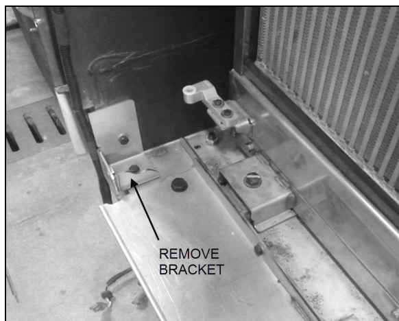
FIGURA 49: SOPORTE DE BISAGRA INFERIOR DE COMPUERTA DE RADIADOR
