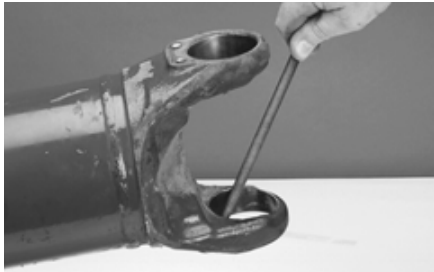
FIGURE 21: LES EFFRITEMENTS DE MÉTAL OU DES ENCAVURES PEUVENT ÊTRE ENLEVÉS AVEC UNE LIME À DENTS FINES ET/OU UNE TOILE ÉMERI.
