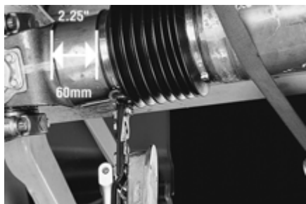
FIGURE 25: POSITIONNER L'EXTRÉMITÉ DU SOUFFLET À LA MARQUE DE 2.25 POUCES (55-60MM) FAITE SUR ÉPAULEMENT DE L'ARBRE.
