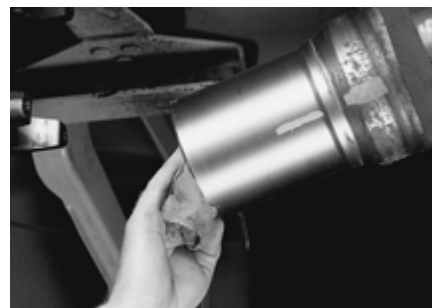
FIGURE 23: NETTOYER LA GRAISSE DU MANCHON CANNÉ
