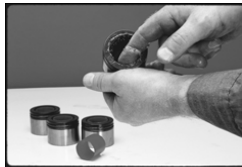
FIGURE 28: GRAISSAGE DES COUPELLES DE ROULEMENT
