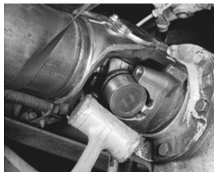
FIGURE 14: DÉGAGER LES EMBOUTS DE JOINTS
