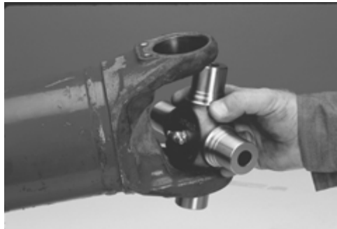
FIGURE 29: POSITIONNER LE CORPS DU JOINT UNIVERSEL À L'INTÉRIEUR DE LA FOURCHE AVEC L'EMBOU DE GRAISSAGE VERS L'INTÉRIEUR POINTANT VERS LE TUBE.
