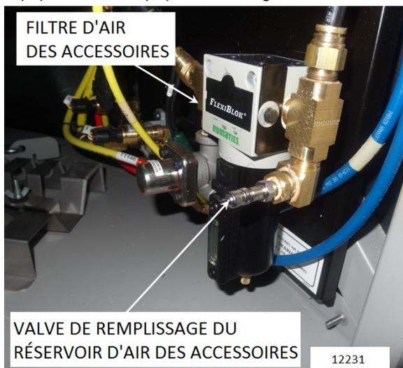
Figure 4: Filtre du COMPARTIMENT DE SERVICE AVANT
