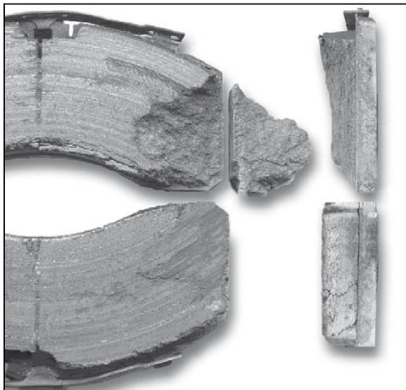
Figure 21: Plaquette de frein avec dégradation importante (non ADMISSIBLE)
