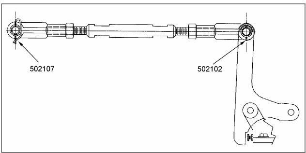
FIGURE 1: BRAKE PEDAL ROD LINKAGE
