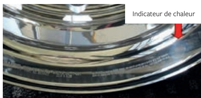
Illustration 13-2 Indicateur de chaleur sur le bord de la roue
