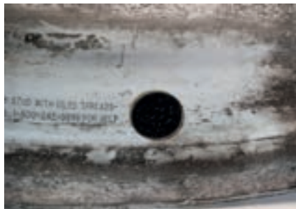
Illustration 13-10 Indicateur de chaleur carbonisé à côté du marquage, à partir de 2009 (vu de plus près).
