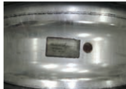
Illustration 13-11 Indicateur de chaleur carbonisé au niveau de la base creuse de la jante, à partir de 2009.
