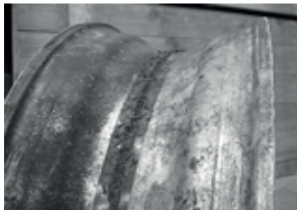
Illustration 13-7 Décoloration de la jante avec caoutchouc carbonisé
