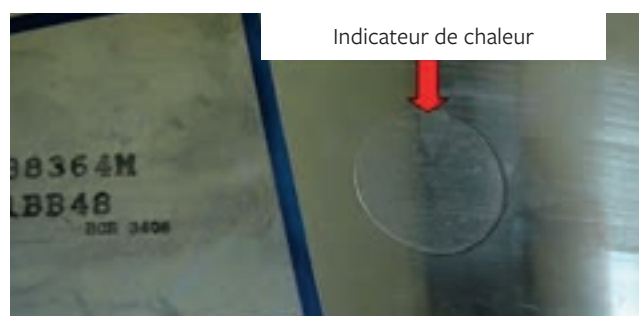
Illustration 13-3 Indicateur de chaleur au niveau de la base creuse.
