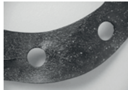
Illustration 13-8 DiscMate pour roues Alcoa® Wheels carbonisé ou autres joints de protection en nylon
