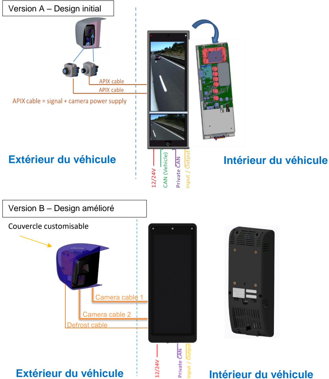
Figure 1: schema de fonctionnement pour les versions A et B
