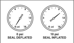
INFLATABLE SEAL PRESSURE GAGE
