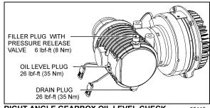
**RIGHT ANGLE GEARBOX OIL LEVEL CHECK** 05118
