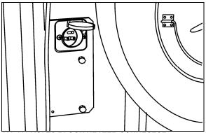
110-120 VOLTS BLOCK HEATER CONNECTOR 06650
